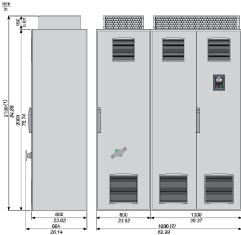
(1) + 200 mm / 7,87 in. Optional mit Schaltschranksockel oder höherer Schutzart IP54.
