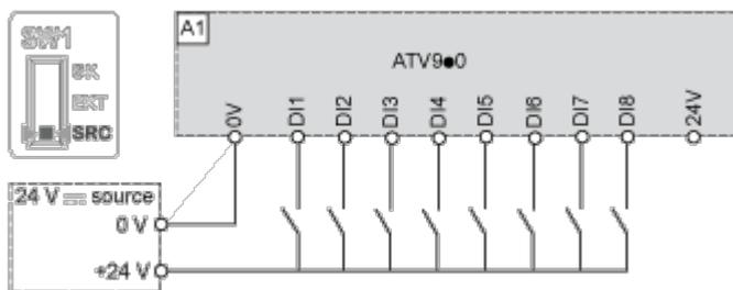
**Schalter in Stellung „SK (Senke)“ bei Verwendung der Ausgangsversorgung für die Digitaleingänge**
