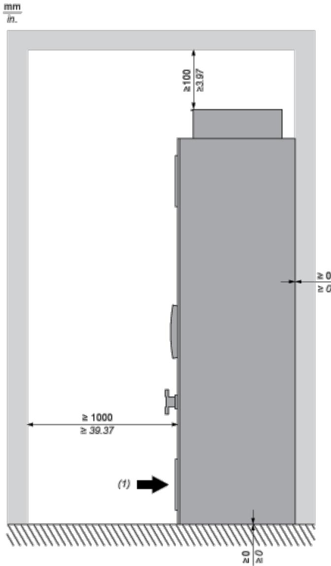
(1) Die Temperatur der zugeführten Luft muss zwischen -10 °C und +50 °C liegen (unter 0°C bei Schrankheizung und über +40 °C mit Derating).
